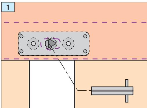
Le module **CEX/ORLY** possède un **contact inverseur étanche 4A/220V**. Ce contact est actionné par la clé de déverrouillage triangulaire dès que celle-ci est tournée pour ouvrir la porte. Le contact ainsi établi permet d'enclencher par exemple, une alarme sonore et l'éclairage de la gaine de l'ascenseur. Une fois la clé retirée, le contact reprend sa position initiale.
